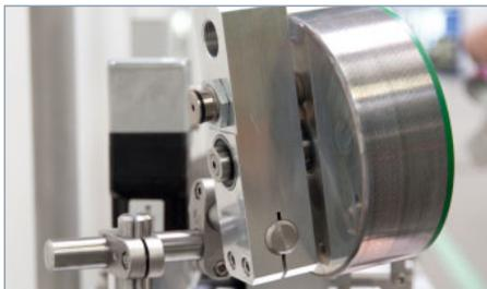
Aufwickleinheit (Reduktion der Handlingszeit, effizientes Arbeitsprinzip)
