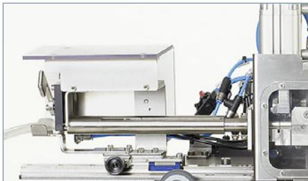
Teleskoprohr mit Lichtschranke (speziell für Blutschlauch 12,2 mm, sehr hohe Präzision)
